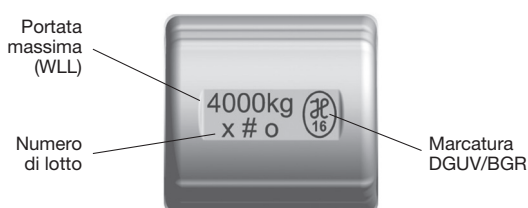
Fig. 2: Descrizione dei componenti e ubicazione dei dettagli di identificazione sul prodotto.
